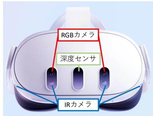
図 2. MetaQuest3 の搭載センサ
