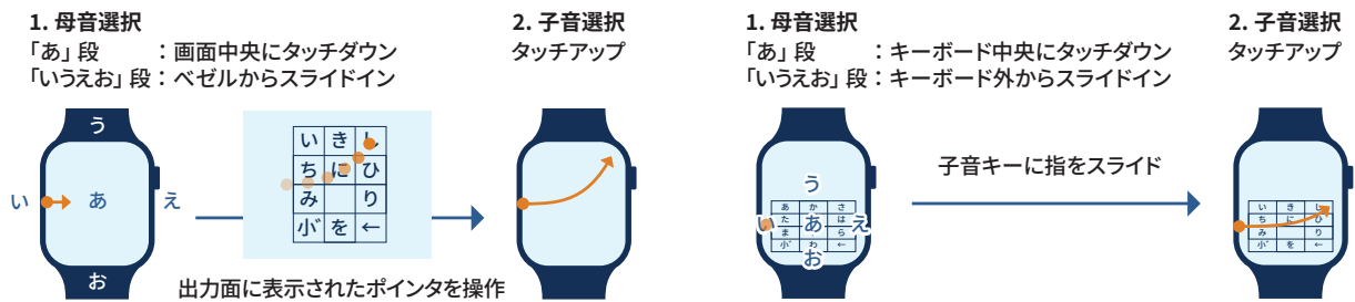
図 2. 本手法の操作 (a：間接タッチ設計，b：直接タッチ用設計)
