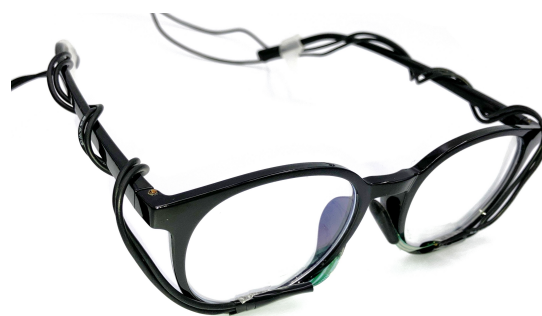
図1. 鼻あてに圧力センサを搭載したデバイス 耳びく、瞬き、歩行、脈拍の測定が可能
