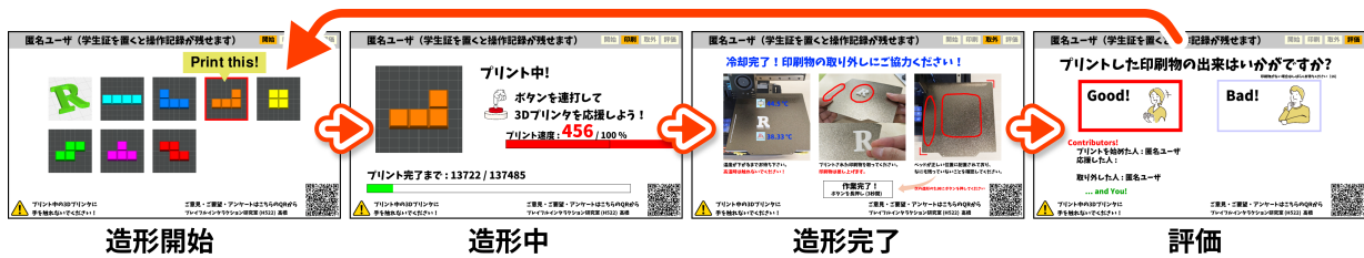
図 3. ディスプレイに表示されるシステム画面. ユーザのボタン操作や3Dプリンタの造形工程に応じて画面を書き換える.
