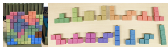
図 2. 提案システムが出力するテトリスのブロックと Rainbow Filament による色の变化。
