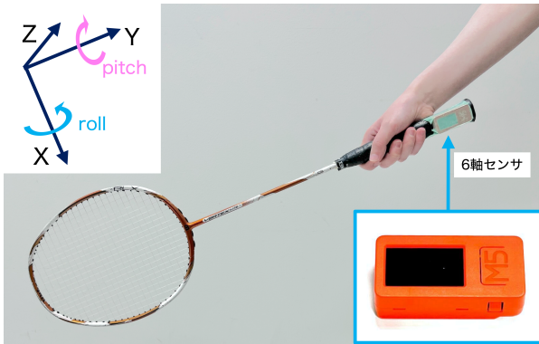
図 2. ラケットの持ち方. グリップ部に M5StickC Plus を設置している. Z 軸マイナス方向がフォア方向.
