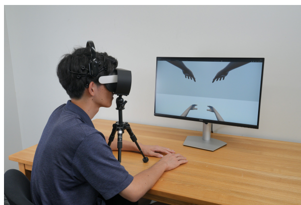
図 1. MI-BCI を用いた VR 環境における四本腕制御システムの様子。ユーザーは各腕を動かすイメージにより四本腕を制御する。ヘッドマウントディスプレイは BCI 機器との干渉を防ぐために三脚に固定した。
