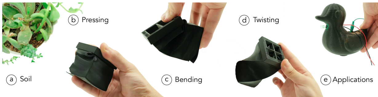
図 1. カソードに圧力が加わると SMFC の出力電圧が力に応じて変化するため、土を力覚センサとして使用することで、(b) 押す、(c) 曲げる、(d) ねじるという動作に反応する触覚インタフェースを作成でき、様々なインタラクションデザインへの応用が可能となる。
