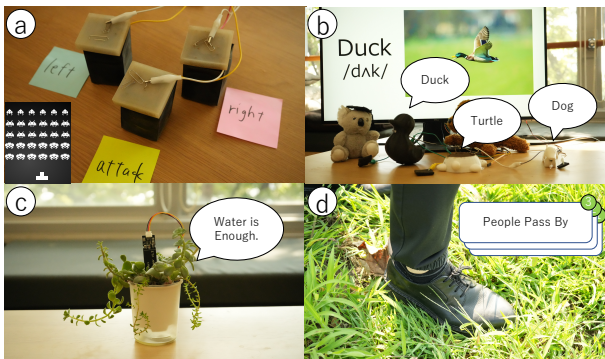
図 2. (a) ゲームを操作するボタン、(b) 押すと対応する画像と発音が表示される動物モデル、(c) 土壌の水分量を通知する植物、(d) 通過する人の数を記録する芝生
